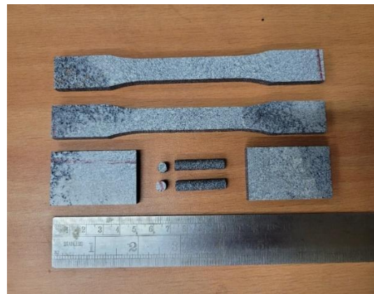
(d) Specimen for tensile test, hardness test and Tribo test
