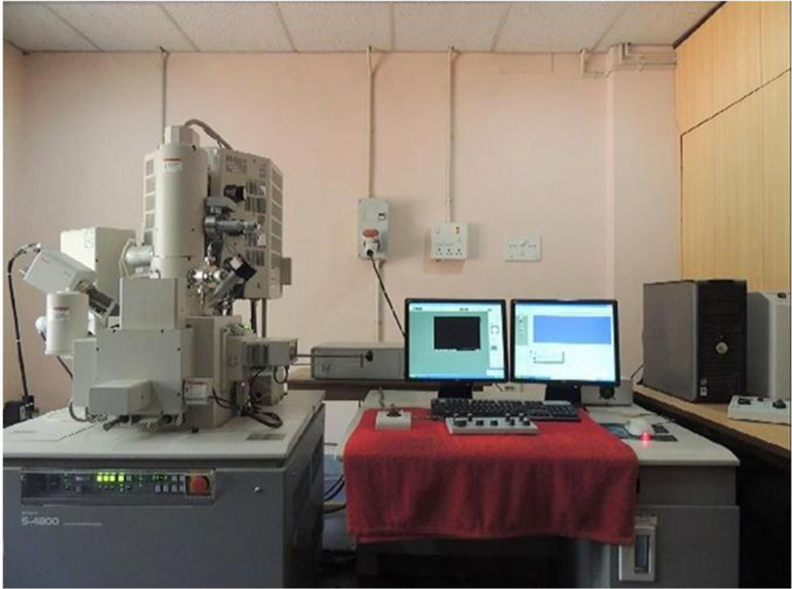
Fig.3.4 FESEM (Hitachi S-4800) set up
