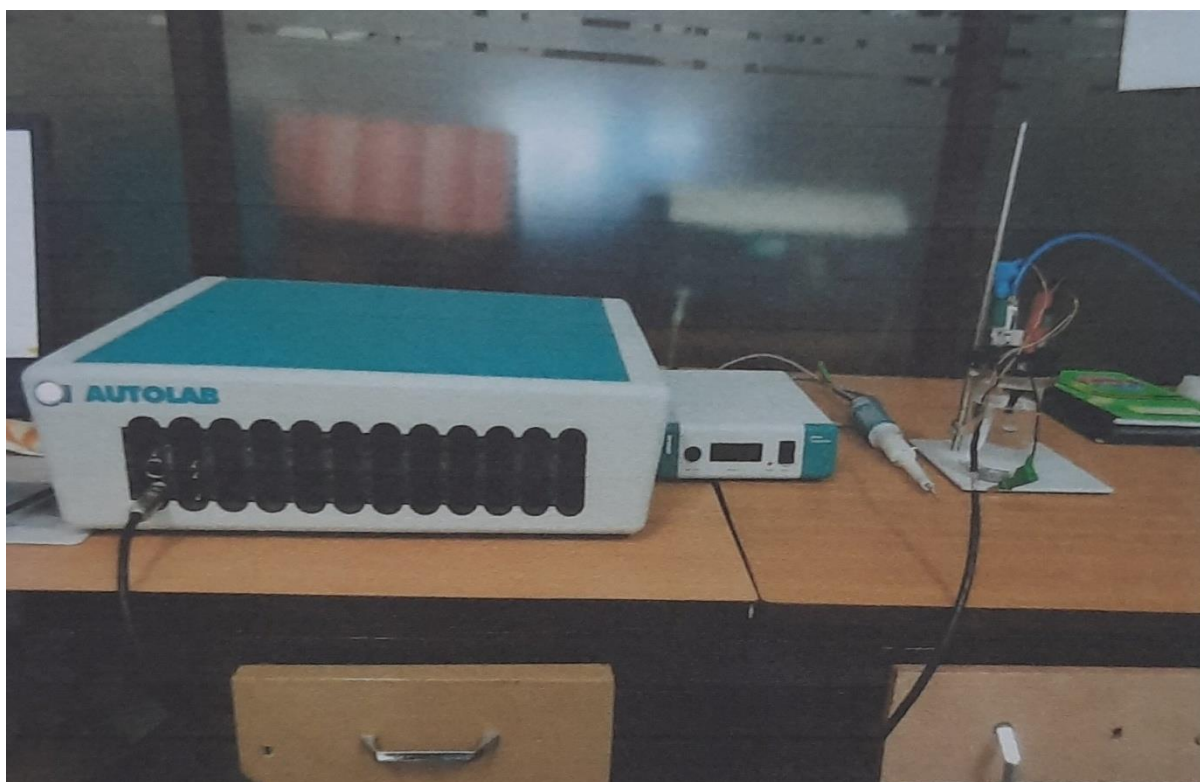
Fig. 4.16: Autolab PGSTAT (M204) potentiostat/galvanostat Setup
