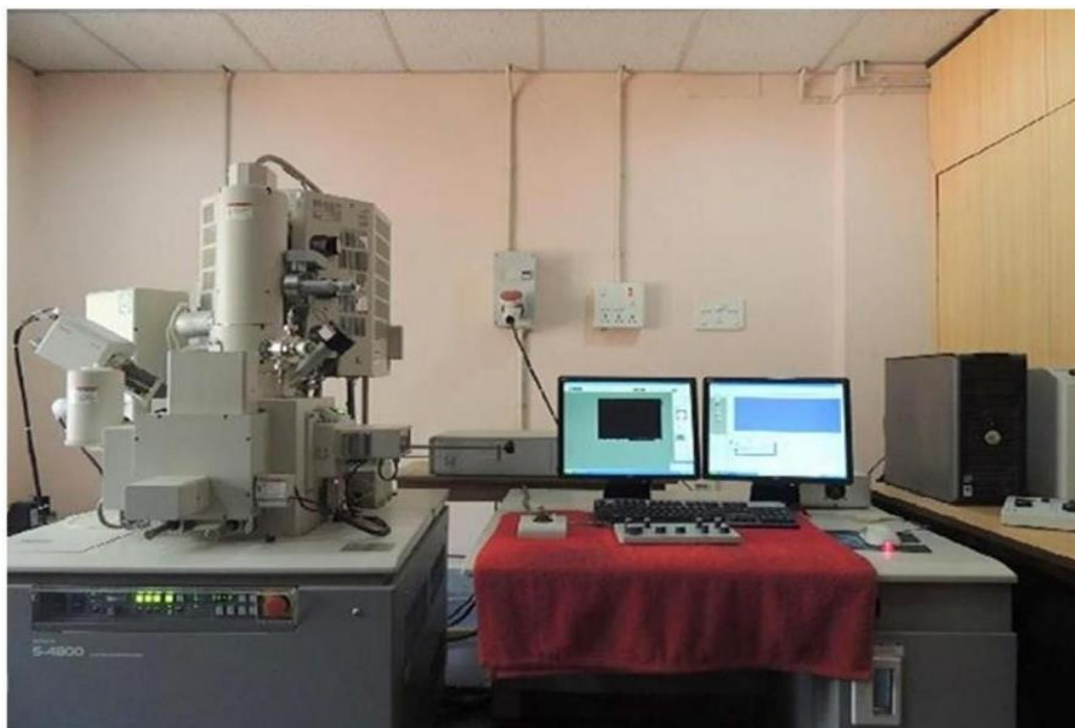
Fig. 4.13: FESEM (Hitachi S-4800) set up
