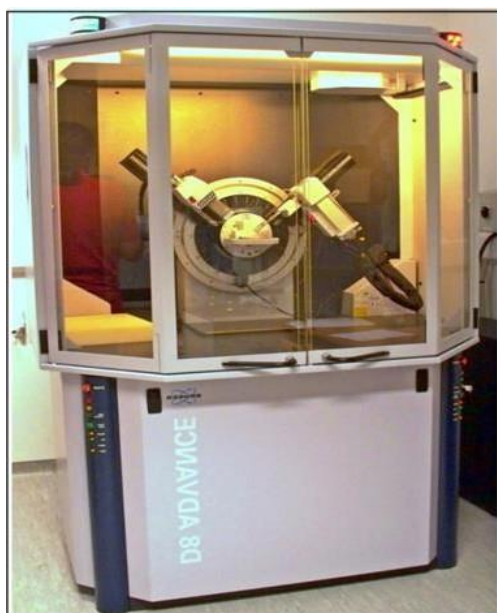
Figure 7 : XRD test arrangement.
