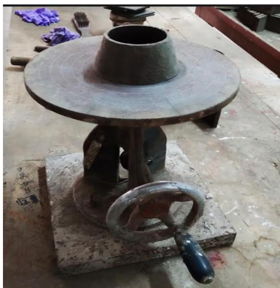
Fig 3.2 Mini Slump-Cone with flow table
