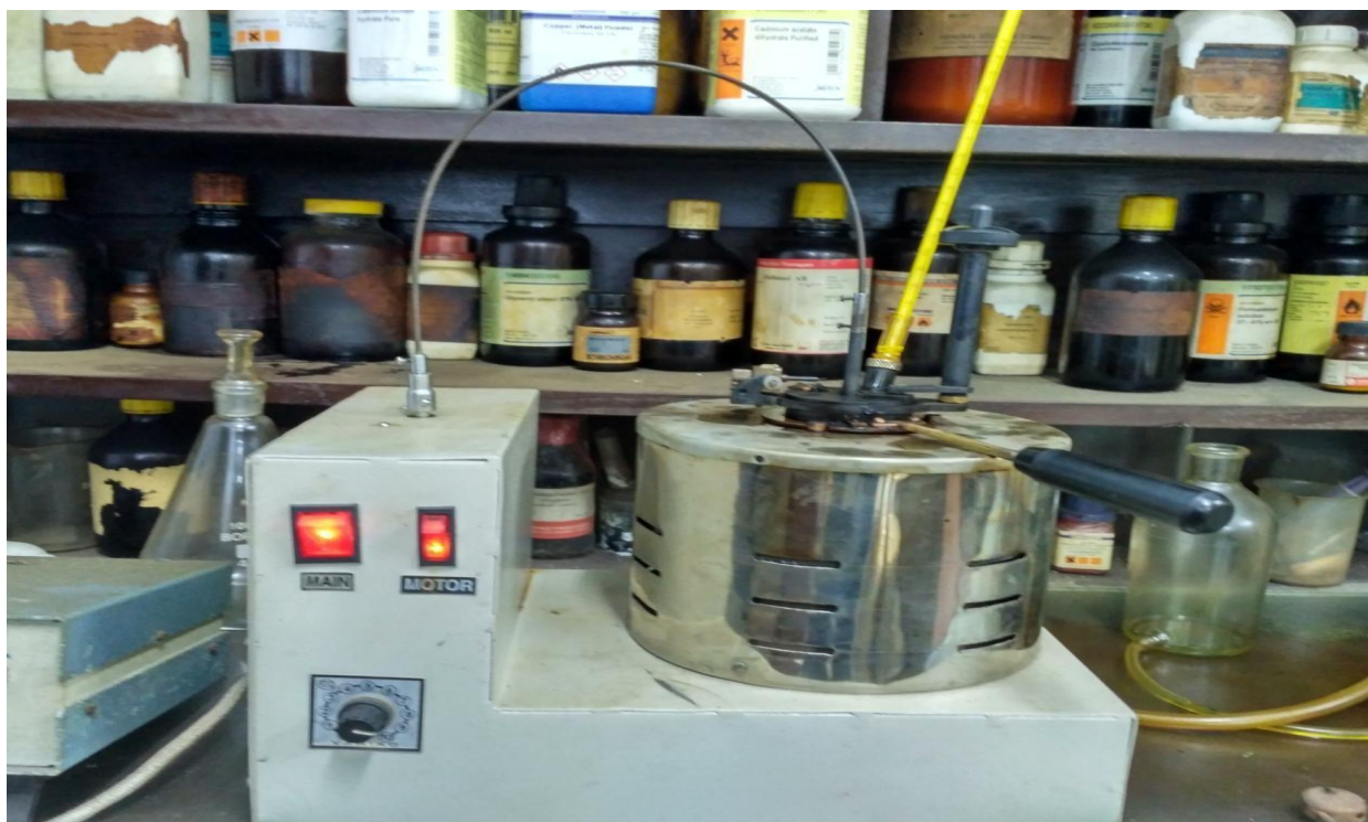
Fig-6.3 : Flash point testing apparatus
