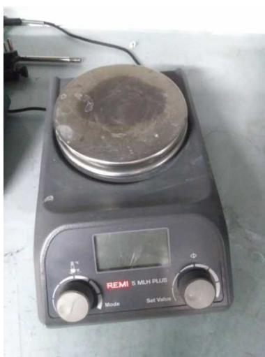
Fig.3: Magnetic Stirrer Model-5MLH PLUS
