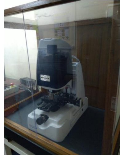
(d) 3D surface profiler (Bruker, ContourGT-K 3D)
