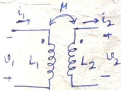
$$-v_1 = L_1 \frac{di_1}{dt} - M \frac{di_2}{dt} \Rightarrow v_1 = -L_1 \frac{di_1}{dt} + M \frac{di_2}{dt}$$
