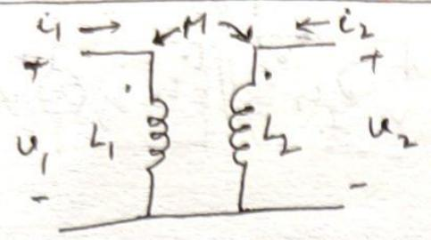
$$\therefore v_1 = L_1 \frac{di_1}{dt} + M \frac{di_2}{dt} \quad \dots (16)$$
