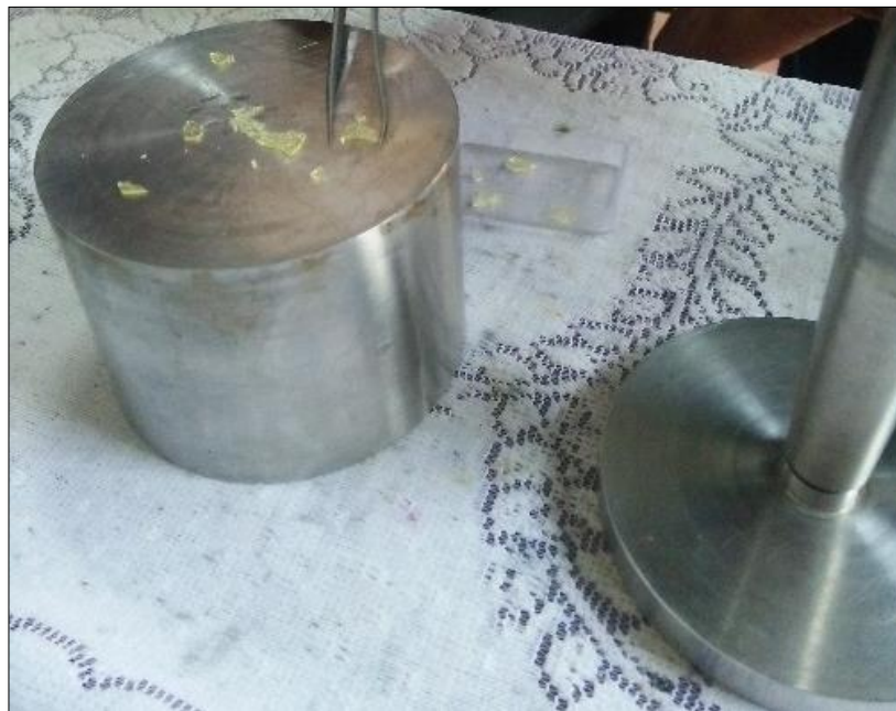
Fig. 2.1 (d) Quick pressing of the Melt
