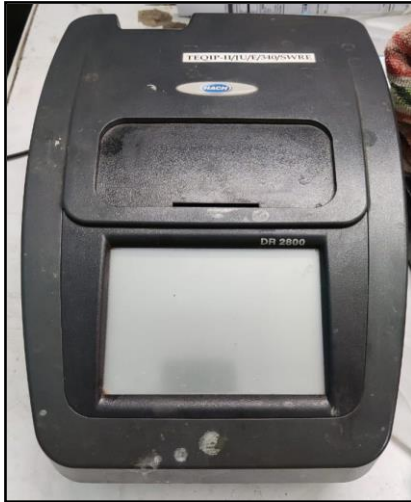
Figure 6 Spectrophotometer DR 2800 ( \text{SO}_4^{2-} , \text{PO}_4^{3-} & \text{NO}_3^- )
